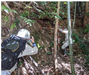
図1 風化した岩が露出した崩壊危険性の高い急傾斜地の例。出石伝建地区に複数箇所確認できた。
