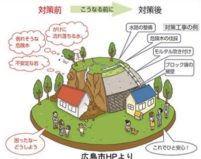
図2 崩壊のリスクを低減・回避させるためのハード対策。斜面条件に応じた様々な工法が実用化されている。
