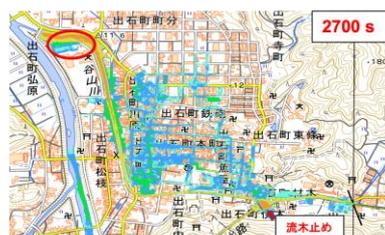
図1 現在設置されている流木止めが閉塞するケース
