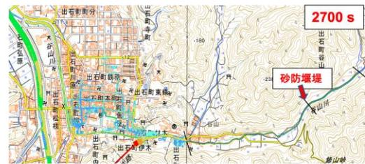
図2 谷山川上流部で流木及び土砂を捕捉する対策を行ったケース
