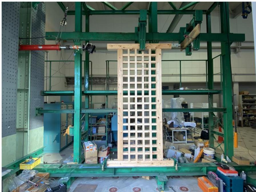
図13 格子壁試験体の静的載荷試験
