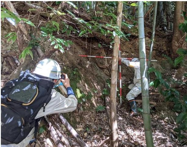
図1 風化した岩が露出した崩壊危険性の高い斜面
