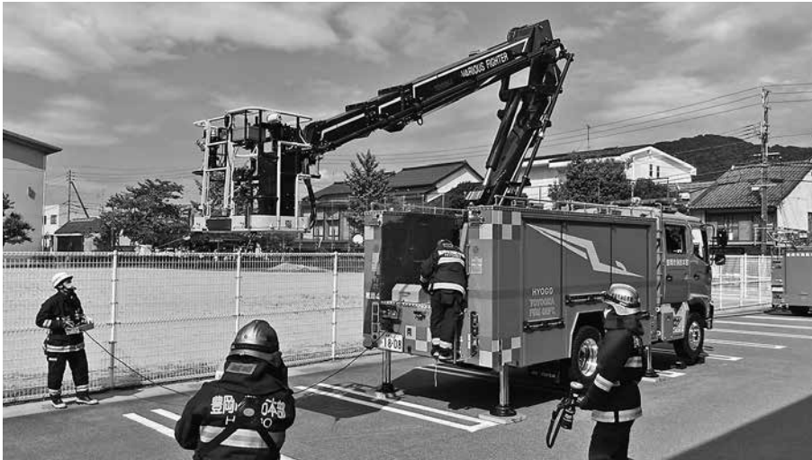
活躍中のブーム付多目的消防ポンプ自動車（消防城崎分署）
