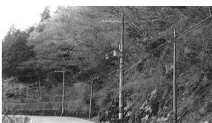
倒木による停電の可能性が高い電線に覆いかぶさる樹木
