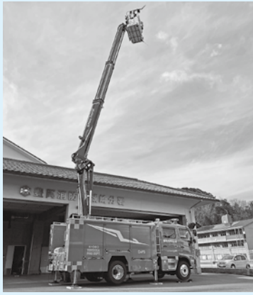
▲【全長】約7.4m 【全幅】約2.3m 【車両重量】約12トン（乗員6人） 【駆動】4WD
