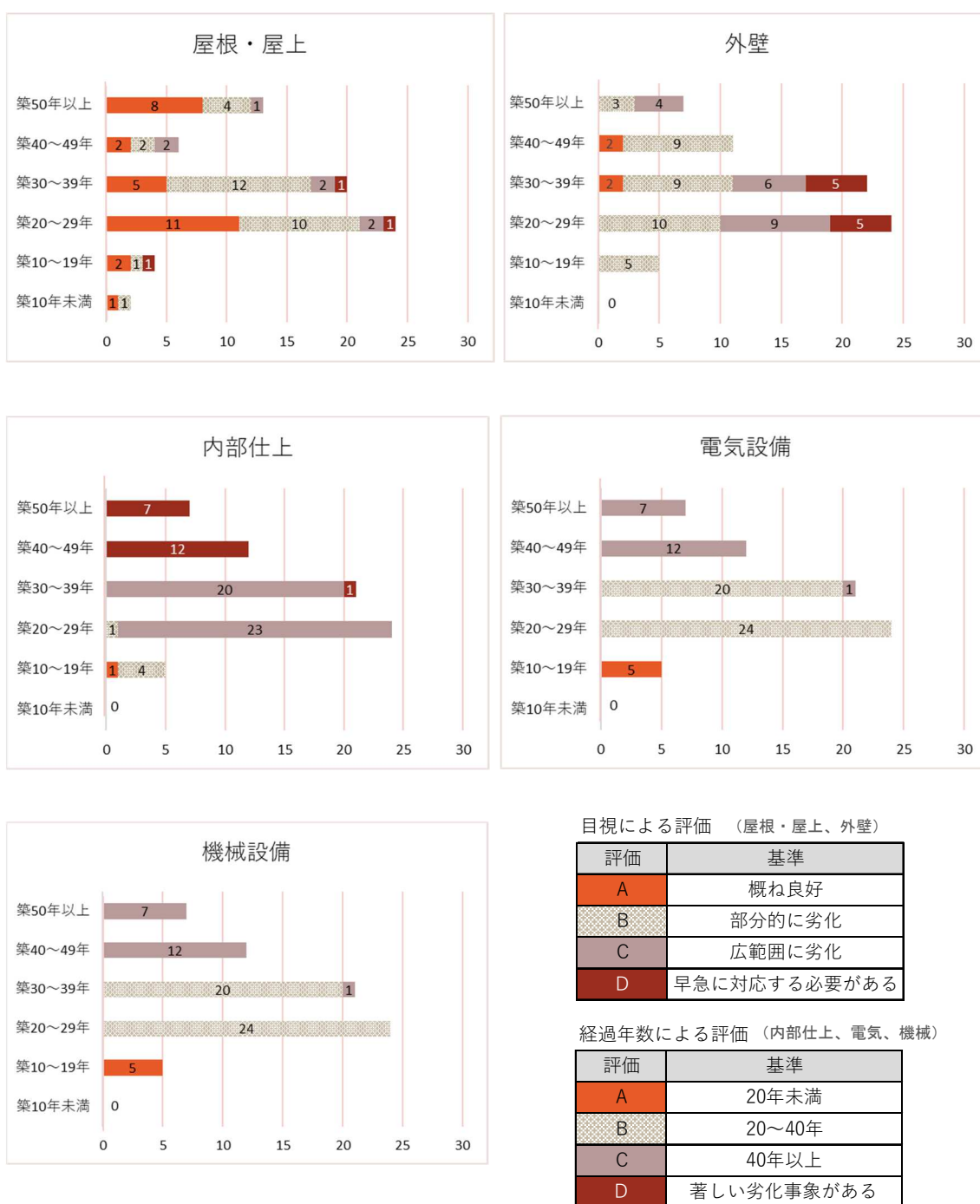
図表 3.19 築年別（部位別）劣化状況
