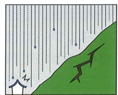
山の斜面に亀裂が走った
