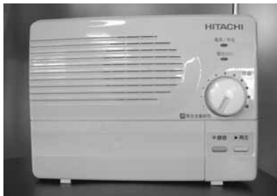
▲ 4月から竹野地域、7月から但東地域で防災行政無線を運用開始。各家庭に設置する戸別受信機
