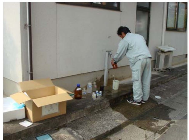
給水栓からの採水状況
