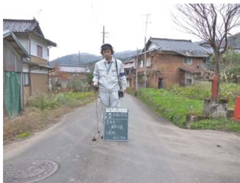
漏水調査の状況
