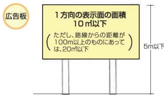
広告板：広告表示が板状で、1面又は2面に表示されるものをいう。
